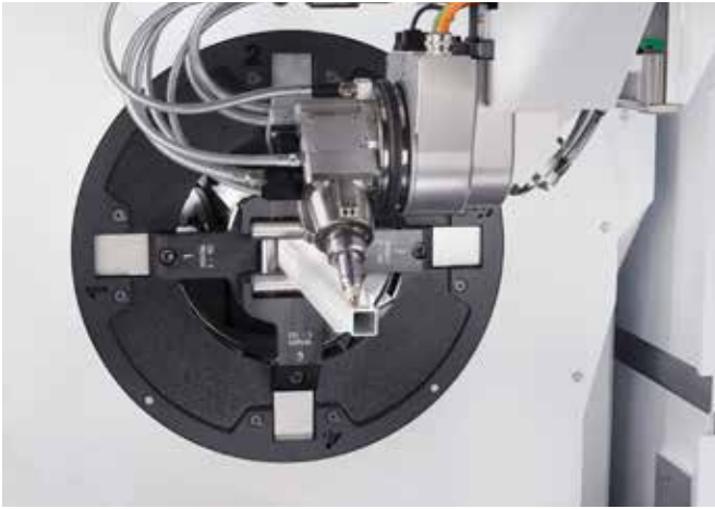
Diese Laser-Rohrschneidmaschinen schneiden vollautomatisch eine große Vielzahl an Sonderprofilen.
