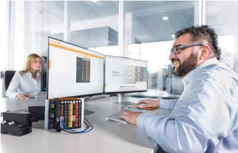
Ein im Feldbus-Koppler integrierter Web-Server gestattet ein einfaches und schnelles Prüfen des Anlagenstatus.
