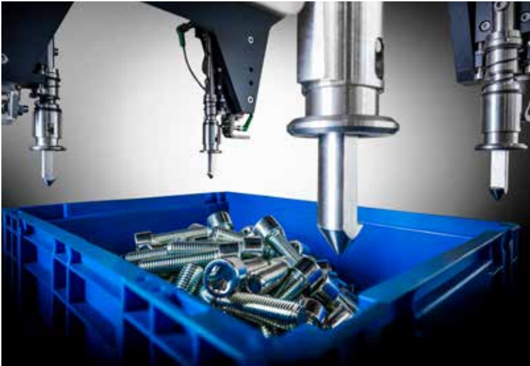
Zur sicheren Aufnahme der Kleinladungsträger an den dafür vorgesehenen Aussparungen dient ein spezieller, von VMT entwickelter Multifunktionsgreifer.
