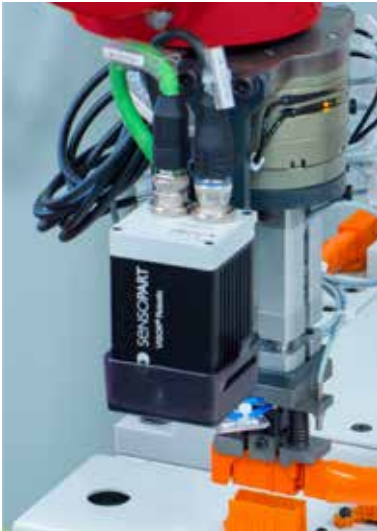
Zur Bestimmung der Bauteilposition wird in der Regel ein Visor Robotic in den Robotergreifer integriert.
