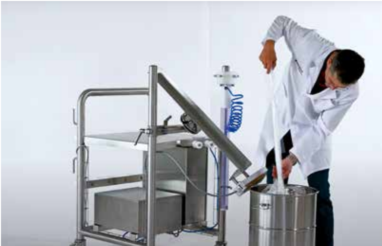
Die Probe wird mit der Lanze nach dem sauberen Durchstechen des Gebindes aus dem Gebinde entnommen.
