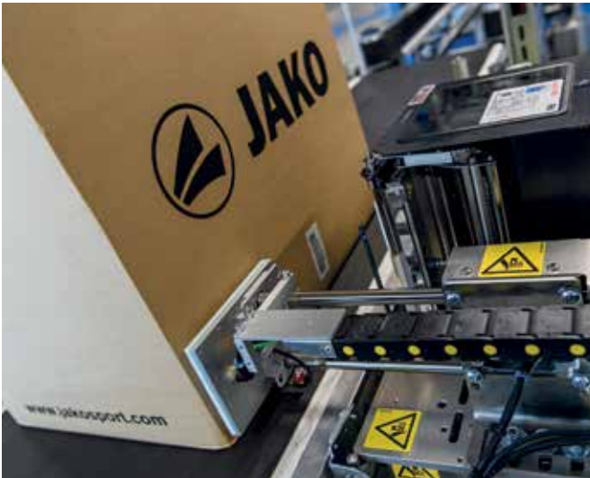
Während der Karton den Stempel passiert, bleibt der vordere Teil des Etiketts seitlich haften, sodass das komplette Etikett automatisch mitgenommen wird.
