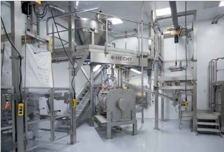
Für den Mischprozess kommt der Pflugscharmischer von Lödige zum Einsatz.
