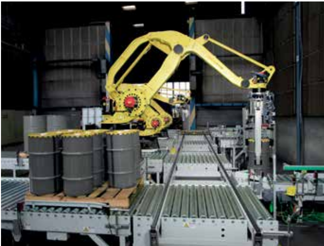
Der robotpac von Beumer kann Fässer palettieren.
