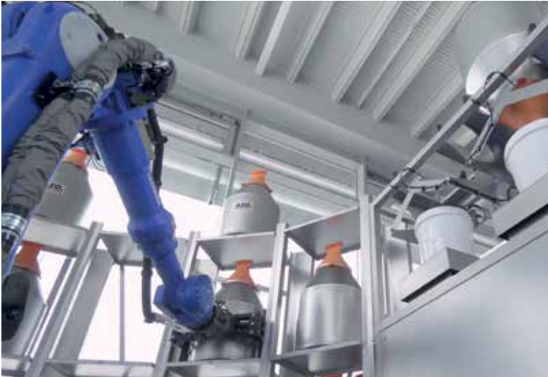
Mit Hilfe des Roboters kann eine höchst variable Anzahl an Kleinstmengen bis 10 kg vollautomatisch dosiert werden.
