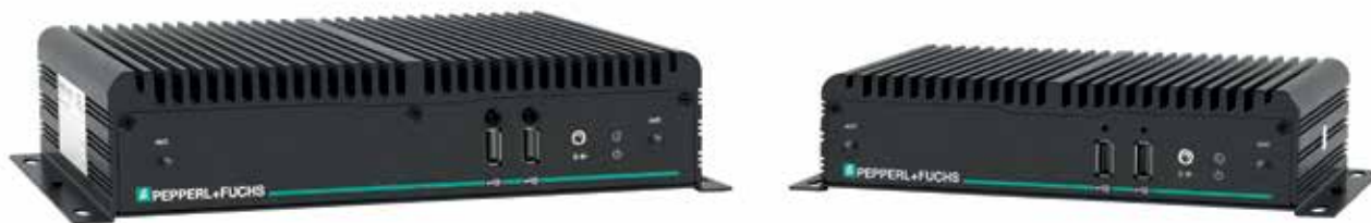
Der neue BTC14 (links) ergänzt den BTC12 (rechts) um eine industrielle Box Thin Client Variante mit vier DisplayPort-Ausgängen. Damit lassen sich bis zu vier Ultra-HD-Monitore betreiben.
