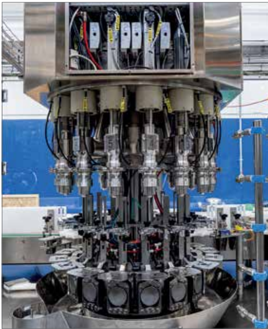
Die Dreh-Abfüllmaschine führt eine vollelektronische Kontrollmethode für die Wägezellen und Füllventile ein.
