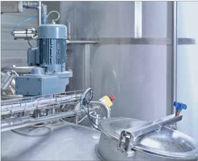
Der Nord-Antrieb erzeugt hohe Zentrifugalkräfte, um Hopfen und Würze zu trennen.
