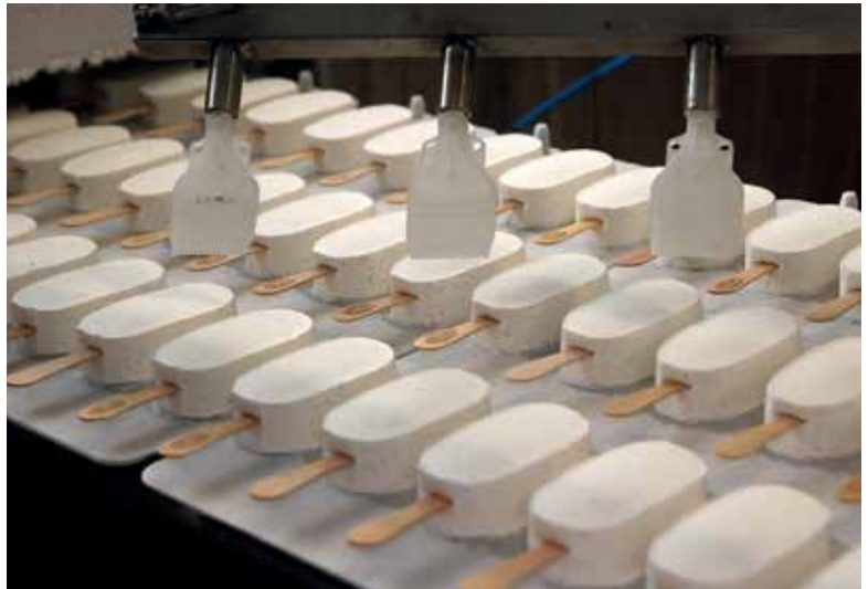
Eis am Stiel kurz vor der Einfahrt in den Froster, wo das Eis auf -40\text{ °C} heruntergekühlt wird.
