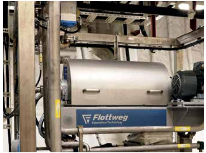
Flottweg-Dekanter reduzieren den bei der Abgasreinigung entstehenden Schlamm direkt an Bord und sparen so bares Geld.
