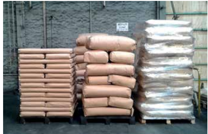
Die mit dem Vakuumpacker abgesackten Säcke lassen sich wesentlich einfacher stapeln, transportieren und sichern (linke Palette) als herkömmlich abgefüllte.
