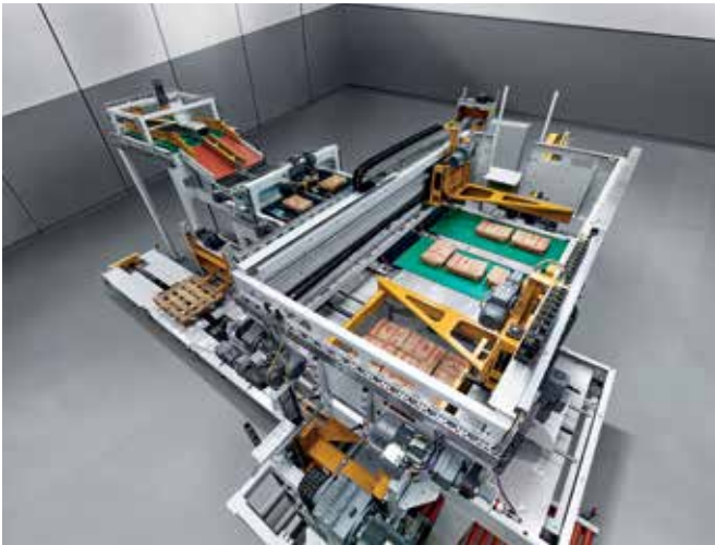
Der Paletpac von Beumer erstellt exakte, stabile und damit platzsparende Sackstapel.
