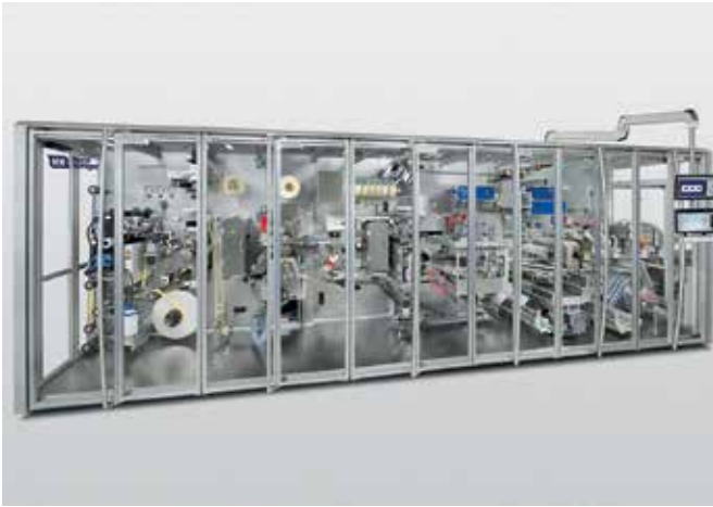
In einer neuen Anlage zur Verpackung von Schmerzmitteln sorgen Bildverarbeitungssysteme an mehreren Stellen für zuverlässige Qualitätsüberprüfungen.
