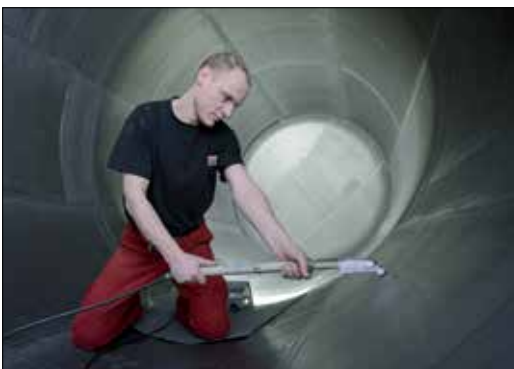
Korrosionsschutz durch Beschichtung, Gummierung oder Ausmauerung – je nach Anwendung.
