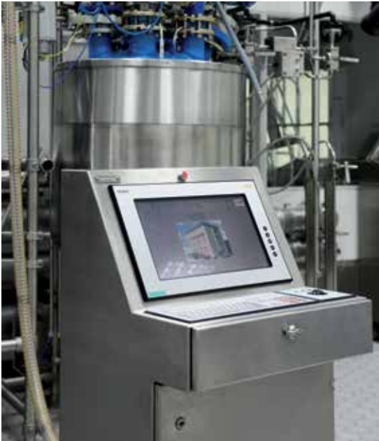
Der Panel-PC Polaris ist für die Virtualisierung von Prozessen im Ex-Bereich ausgelegt.
