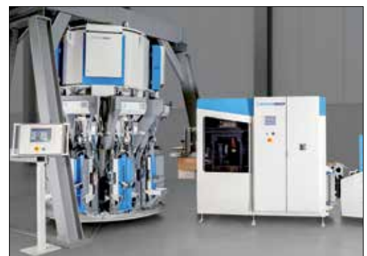
Die Abfüllmaschine BEUMER fillpac R wurde um einen Sackaufstecker und ein Sackbündelmagazin ergänzt.
