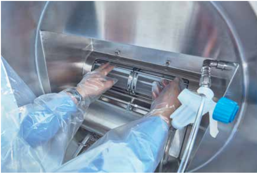
Nachdem die Klappe wieder geschlossen wurde, kann der anhaftende Staub mit Hilfe der Reinigungspistole gebunden werden.
