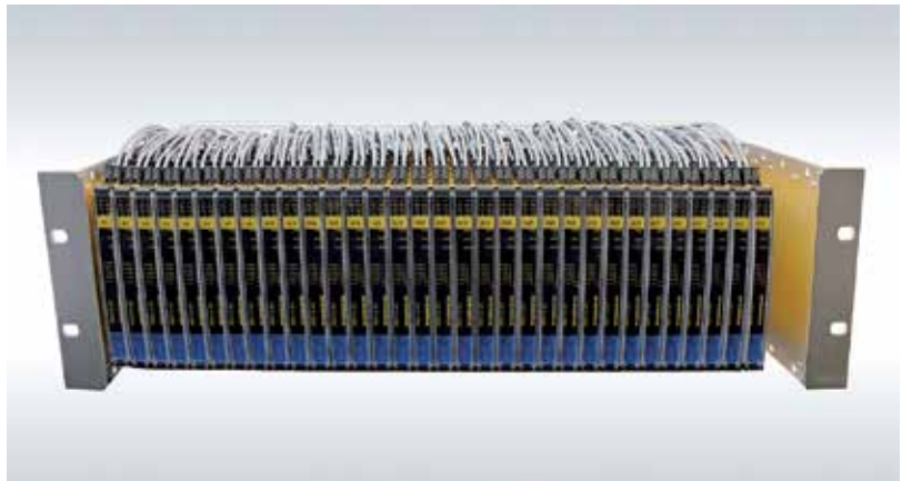
Maßgeschneiderte 19-Zoll-Baugruppenträger mit neuester Interfacetechnik lösen die betagten Karten eins-zu-eins ab.
