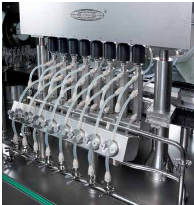
Das CIP/SIP-Dosiersystem reinigt und sterilisiert automatisch Drehkolbenpumpen.
