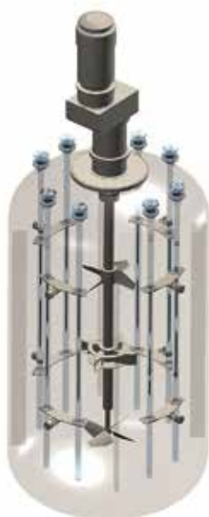
Rührkessel als Photoreaktor mit einer typischen Anordnung der Strahlungsquellen.
