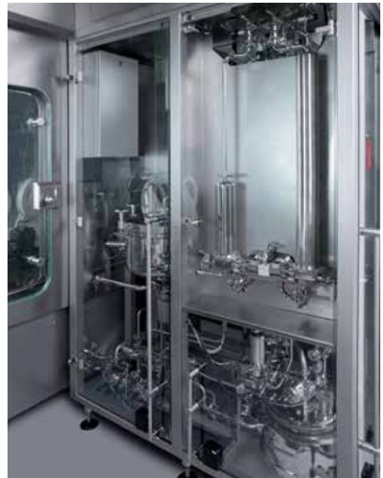
Wartungsfreundliches CIP/SIP-System das direkt an eine Füll- und Ver- schleißmaschine angebaut ist.
