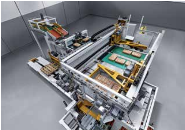
Der Paletpac erstellt exakte, stabile und platzsparende Sackstapel.
