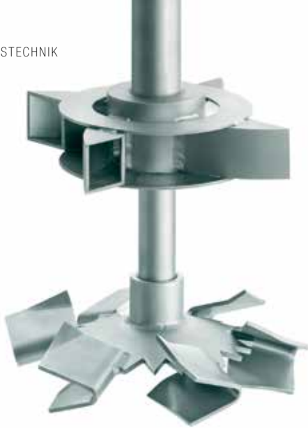
Mit dem Primärdispersierer Ekato Phasejet unten und der selbstansaugenden Turbine Ekato Gasjet oben ist eine kombinierte Begasung möglich.
