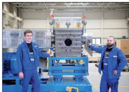
Hochdruckpumpe der BOOSTER Baureihe für den Einsatz in einem Polystyrol-Prozess
