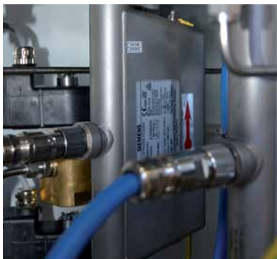
Der Massendurchflusssensor Sitrans FCS200 in der CNG-Tanksäule misst den Durchfluss auch bei stark schwankenden Durchflussgeschwindigkeiten.
