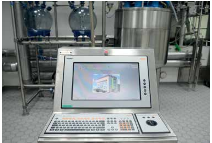
Mobile Visualisierungslösung gebaut auf einem Edelstahlwagen.
