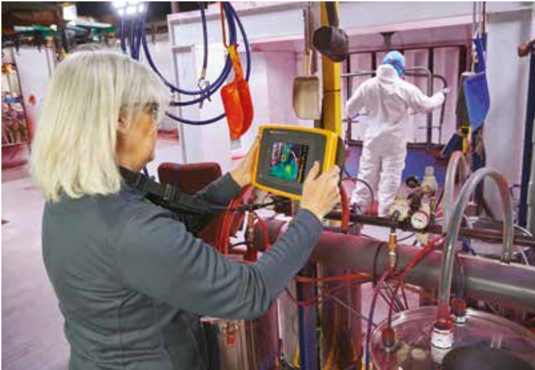
Die tragbare Industrie-Schallkamera ermöglicht eine schnelle und genaue Lokalisierung von Luft-, Gas- und Vakuumecks in Druckluftsystemen, selbst in lauten Umgebungen.
