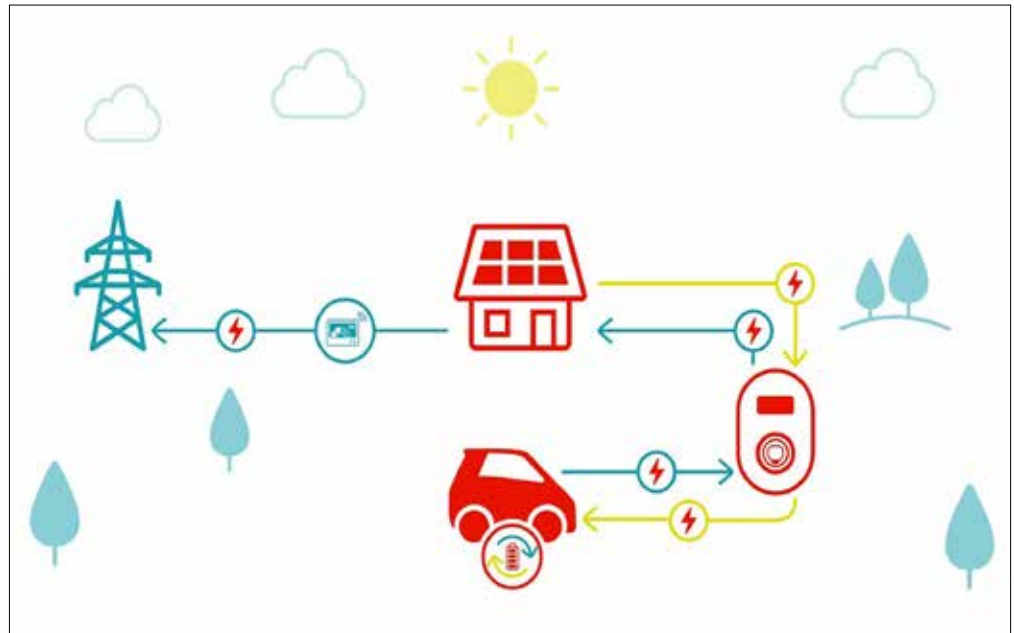
Beim bidirektionalen Laden wird der E-Auto-Akku als Zwischenspeicher für eigenen Sonnenstrom genutzt, der später wieder im Haus verwendet werden kann.
