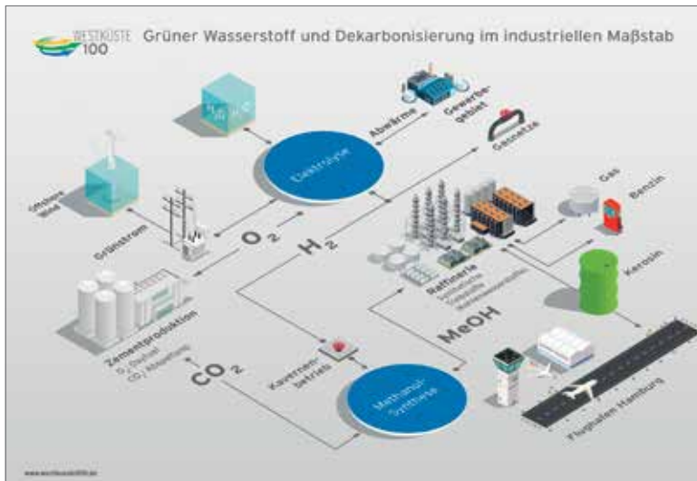
An der Westküste Schleswig-Holsteins: Beim Projekt Westküste 100 wird der erzeugte Wasserstoff sowohl für die Produktion klimafreundlicher Treibstoffe für Flugzeuge genutzt als auch in Gasnetze eingespeist.
