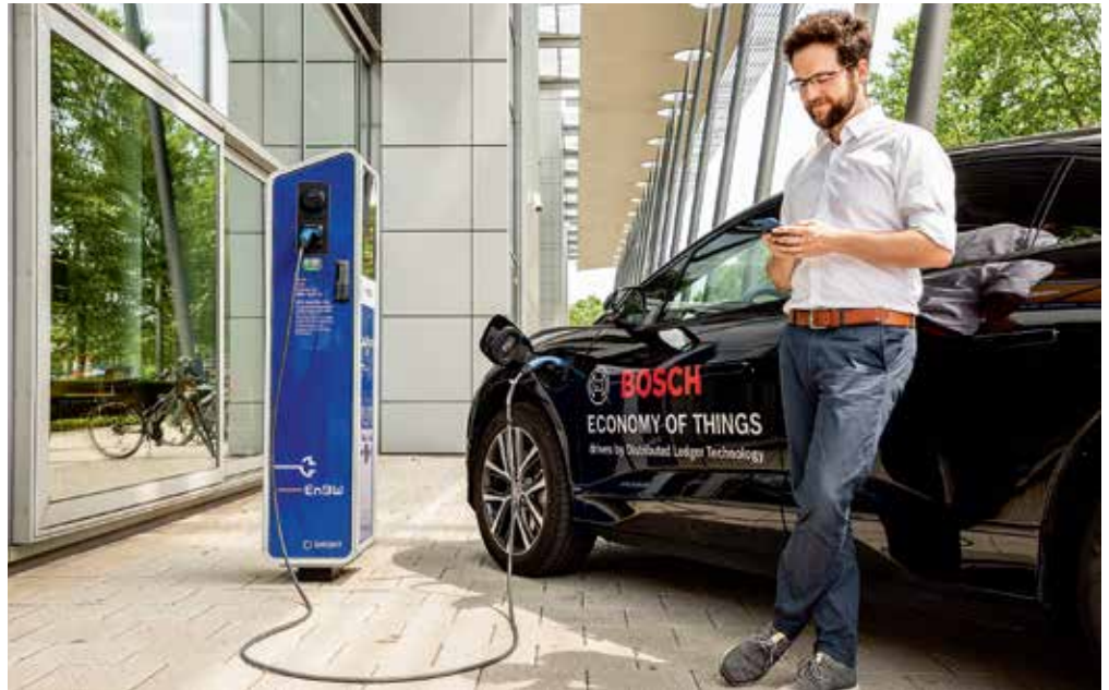
Fahrzeug und Ladesäule können über ihre Software-Agenten unterschiedliche und transparente Preismodelle verhandeln, die dem Fahrer in Echtzeit zur Auswahl angeboten werden.
