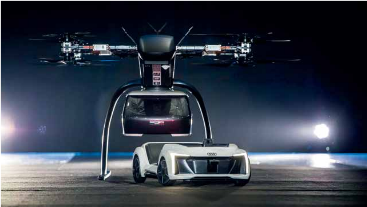
Das neuartige Flugtaxi-Konzept kombiniert ein selbstfahrendes Elektroauto mit einer Passagierdrohne. Beim ersten öffentlichen Testflug hat das Flugmodul eine Passagierkapsel zielsicher auf der Fahrzeugplattform abgesetzt. Diese fuhr anschließend autonom vom Testgelände. Noch handelt es sich um ein 1:4-Modell.
