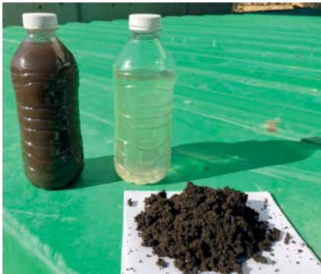
Vorher-Nachher-Vergleich: Links zu sehen ist Schlamm vor der Entwässerung, rechts die Flüssigphase nach der Zentrifuge und daneben der ausgetragene Feststoff.
